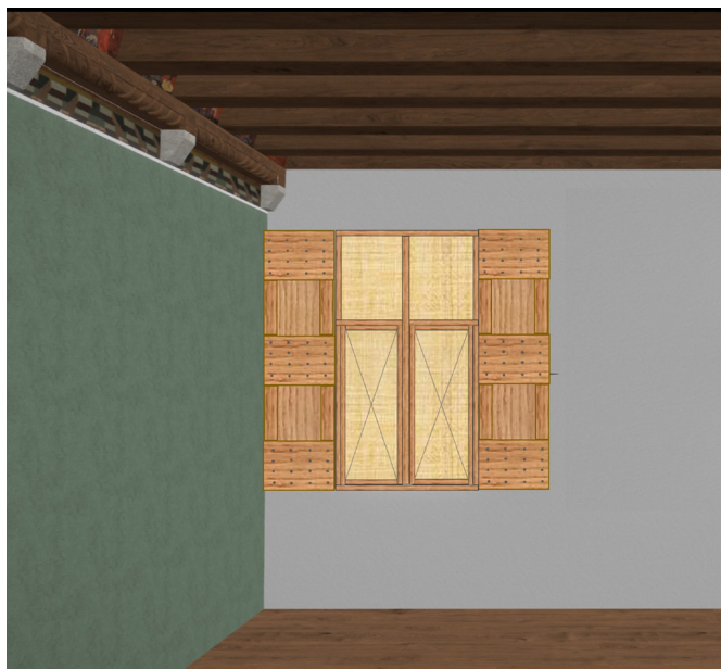
Fig. 7. Udine, Palazzo Vanni degli Onesti, piano primo, modello preliminare per la restituzione digitale 3D di una finestra dotata di portelli e impannate.
