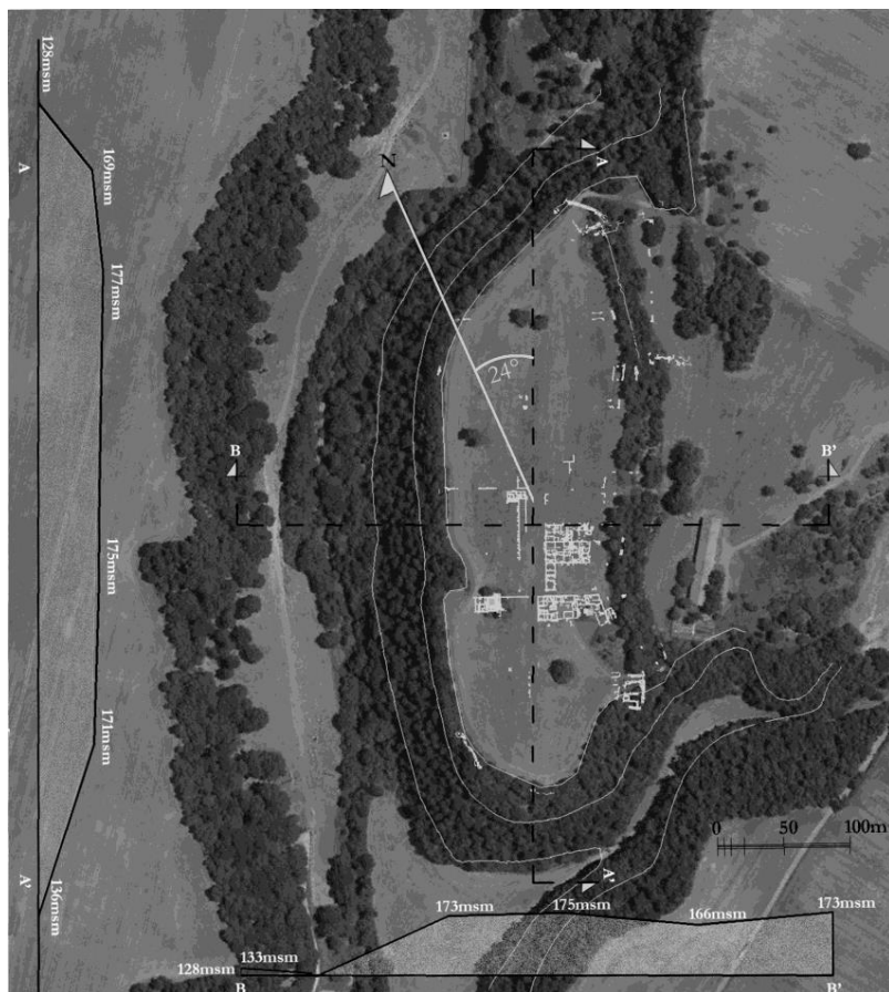
Fig. 2. Inquadramento ambientale e orografico di Civita Musarna con evidenza dell'angolo tra il Nord geografico e l'asse longitudinale dell'abitato. Nell'inquadramento sono riportate le sezioni verticali in sito, trasversale e longitudinale, al fine di evidenziare le caratteristiche orografiche del luogo
