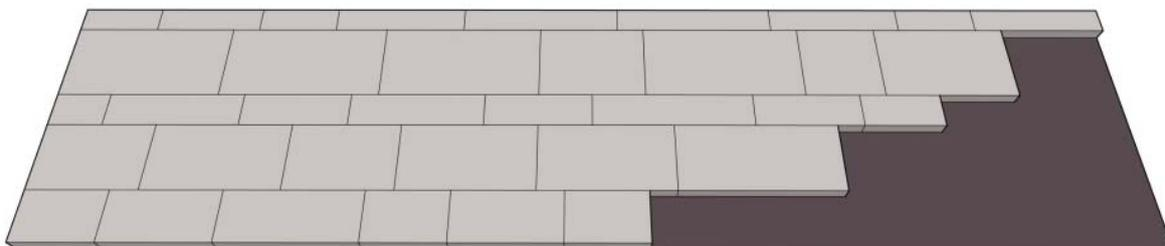
Fig. 22. Lastricato con schema a filari paralleli a giunti sfalsati aventi larghezza differente.
